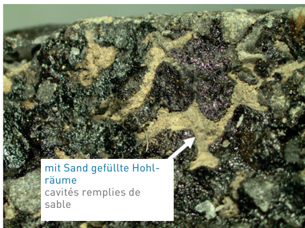
Schichttiefe 0–20 mm: Hohlräume verschmutzt . Profondeur de couche 0–20 mm: cavités encrassées.
